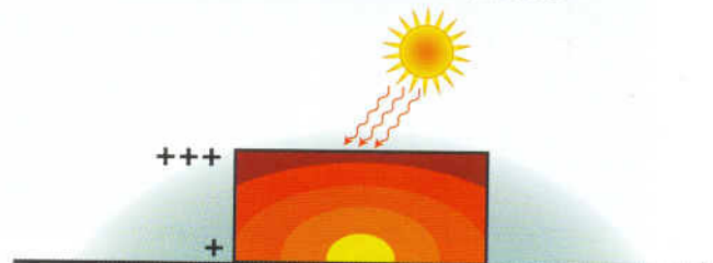
L'écart de température entre la couche d'adobe et le centre
