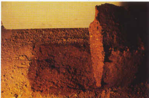
Adhésion de l'adobe à la terre à cause de l'absence de matière isolante comme du sable ou de la cendre
