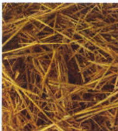
Ajout de fibres végétales pour fixer les briques (adobes)
