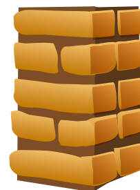
Point de convergence de deux murs où intervient l'emboîtement entre les pierres
