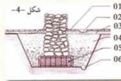
شكل 4- 01- بلاط من الحجر 02- تصريف للمياه السطحية 03- طبقة من الطين الكلسي 04- حصى يشكل مصفاة للمياه 05- ركيزة من الخرسانة المسلحة 06- فتاة مقبولة
