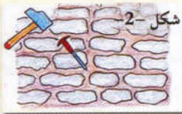
شكل 2- تنظيف الوصلات JOINTS
