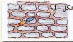
شكل 1- تنظيف الوصلات JOINTS
