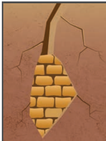
ملء تجويف الشقوق بنفس المواد المستعملة في البناء، بعد التنظيف و الرش
