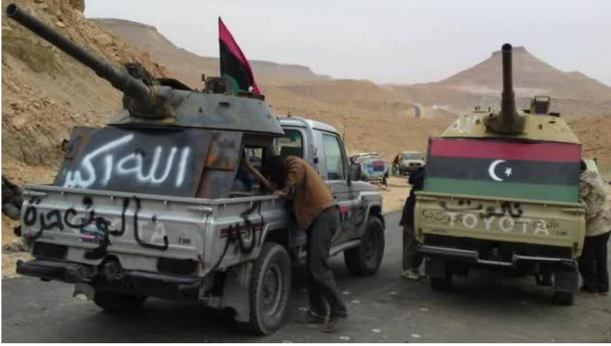
شكل (34) يبين تركيب برج عربة بي إم بي على سيارة تويوتا.
